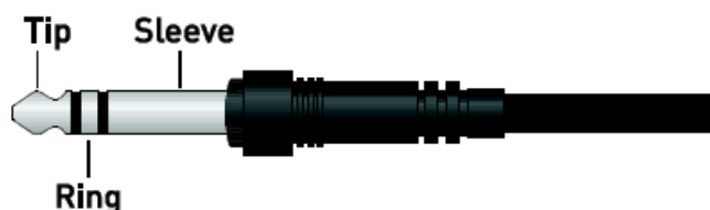
Figure 7-1: Câble TRS, ou Symétrique (Balanced) ou encore "Stéréo".
