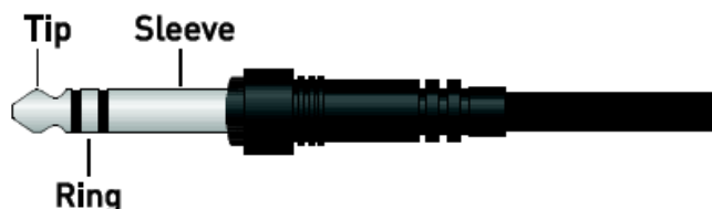
Figure 7-1: Câble TRS, ou Symétrique (Balanced) ou encore "Stereo". Les câbles de guitare « standards » ne fonctionneront PAS avec les pédales d'expression !
